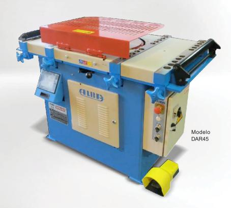
Se incluye un conjunto completo de rodillos y collares para cambiar rápidamente su radio de curvatura.
